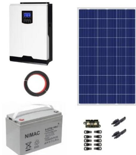
Este sistema es capaz de generar y almacenar energía a partir de sus paneles solares fotovoltaicos. La energía producida se acumula en baterías y es convertida por el inversor a 220V AC para que sea utilizada en cualquier momento las 24 horas del día. El inversor posee un controlador de carga que alarga la vida útil de las baterías y una entrada 220V AC para conectar un generador o la red eléctrica para suplir energía en caso de que sea necesario.
